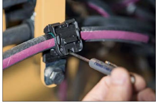
Cırcırlı P-Kelepçe - Kabloları monte etmek ve kelepçelemek için çok yönlü bir yol.
