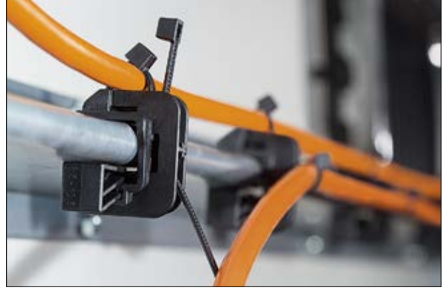
Beam Kelepçe bir kama ile bir kirişe sabitlenebilir. Kelepçenin üst veya arka tarafında iki kablo demetine kadar uygulanabilir.
