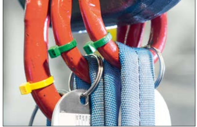
T-Serisi kablo bağları - renk kodlaması için idealdir.
