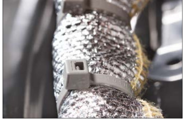
T-Serisi kablo bağları - 5000 saat boyunca +150 °C'ye kadar daha yüksek sıcaklık direnci (PA46).
