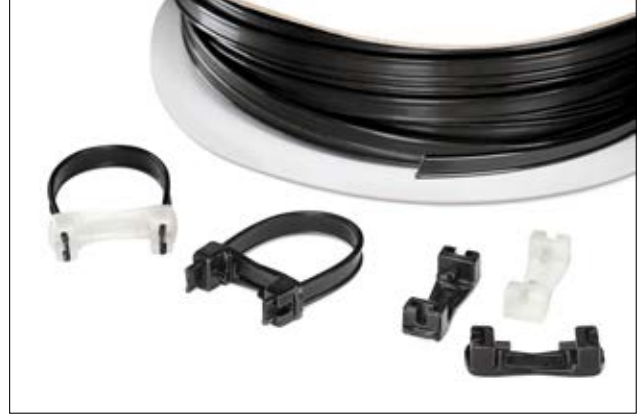
KR-Serisi kablo bağları istenilen uzunlukta kesilebilir ve daha sonra ayrı kablo bağı başlıkları ile kilitlenebilir.
