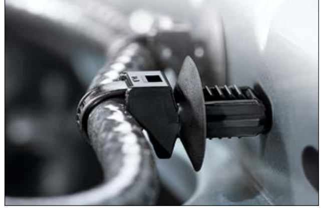
Oval delikler için köknar ağacı tasarımı bu 1 parçalı sabitleme bağı, bükülmeye karşı koruma özelliğine sahiptir.
