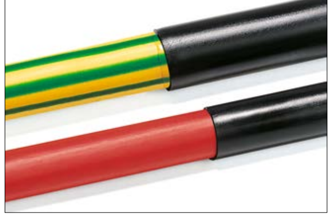
TA32 ve TA42, UL224 sertifikalı yapışkanlı makaronlardır. 3:1 ve 4:1 daralma oranında mevcuttur.
