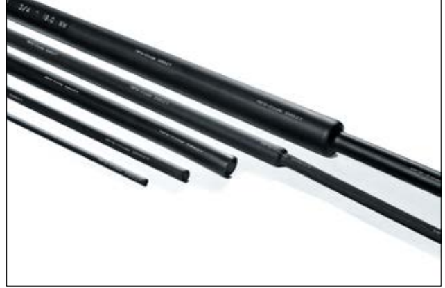
SE28 - Dizele dayanıklı 2:1 yüksek performanslı elastomer ısıyla daralan makaron.
