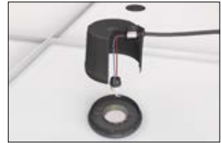
2. Güç kaynağını, birlikte verilen HelaCon Lux kablo konektörleri ile lamba soketine bağlayın ve bayonet kaplin ile kilitleyin.
