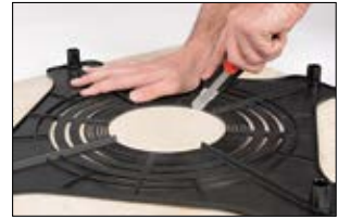
Tavan plakasına sabitleme deliğini kesmek için SpotClip-Plaka'yı şablon olarak kullanın.
