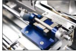
M-BOSS Kompakt kabartma işlemi.
