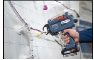
Pille çalışan Autotool CPK hibrit, askı ile kablo bağı uygulama.
