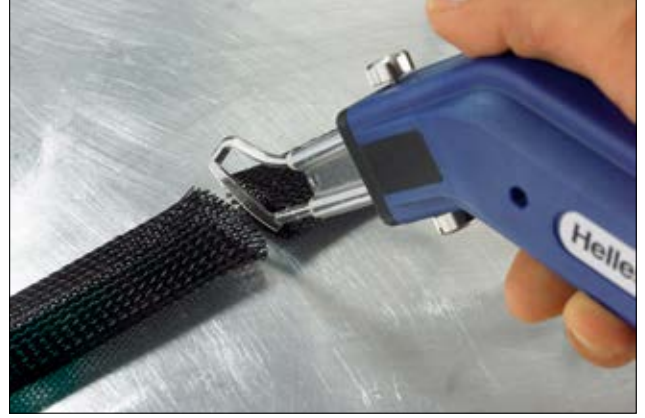
HSG0 sıcak kesme aleti örgülü kılıfın saçaklanmasını önler.
