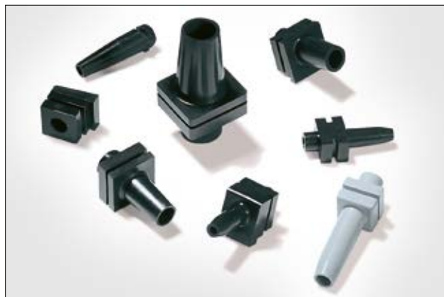
Odgiętki odciążające zabezpieczają przewód zarówno przed zginaniem, jak też przed wyrwaniem z urządzenia.
